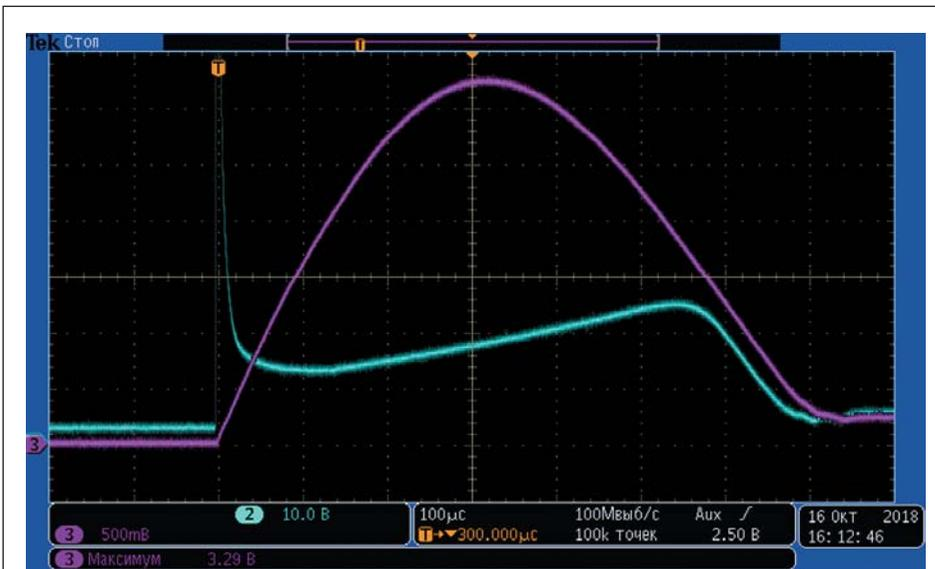
**Рис. 7.** Импульсы тока и прямого падения напряжения в предельном режиме:  $I_p = 164,5 \text{ кА}$ ,  $V_T = 18 \text{ В}$ ,  $V_{cg} = 26 \text{ В}$  ( $I - 25 \text{ кА/дел}$ ,  $V - 10 \text{ В/дел}$ ,  $t - 0,1 \text{ мс/дел}$ )
