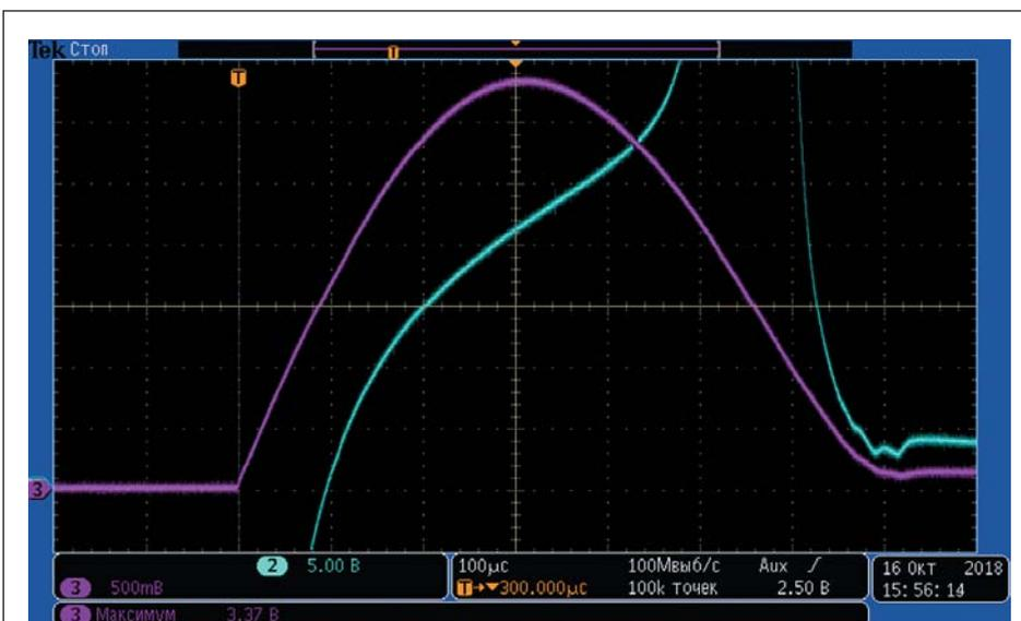
**Рис. 8.** Импульсы тока и прямого падения напряжения в момент пробоя LTT прямым током:  $I_p = 170 \text{ кА}$ ,  $V_{cg} > 35 \text{ В}$  ( $I - 25 \text{ кА/дел}$ ,  $V - 5 \text{ В/дел}$ ,  $t - 0,1 \text{ мс/дел}$ )
