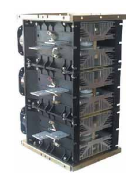
Рис. 7. Силовой блок трехфазного ключа переменного тока с применением трех охлаждающих систем O273
