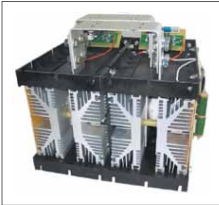
Рис. 6. Силовой блок однофазного ключа переменного тока с применением двух охлаждающих систем O273
